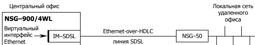
Подключение филиала к центральному офису в режиме "удаленного порта Ethernet"
